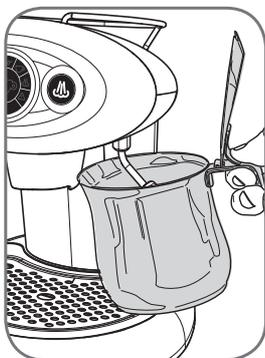
Immergere **completamente** la lancia vapore nel latte.
