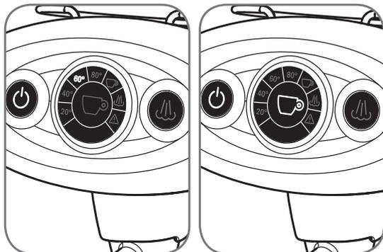
Le icone poste sulla corona circolare si illuminano progressivamente indicando l'aumento della temperatura nel termoblocco.
